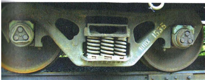
Пружинные рессоры железнодорожного вагона.
