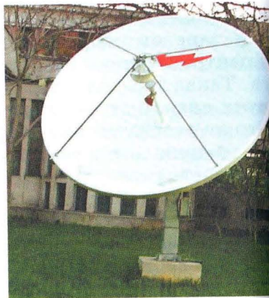
Прямофокусная параболическая спутниковая антенна.
