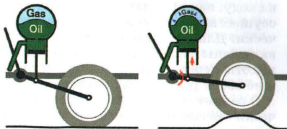
Вид и схема работы баллонной подвески.
